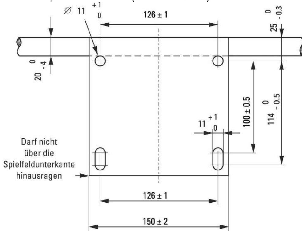
**Bild 6 Montageplatte des Rings (Maßangaben sind Beispiele)**
