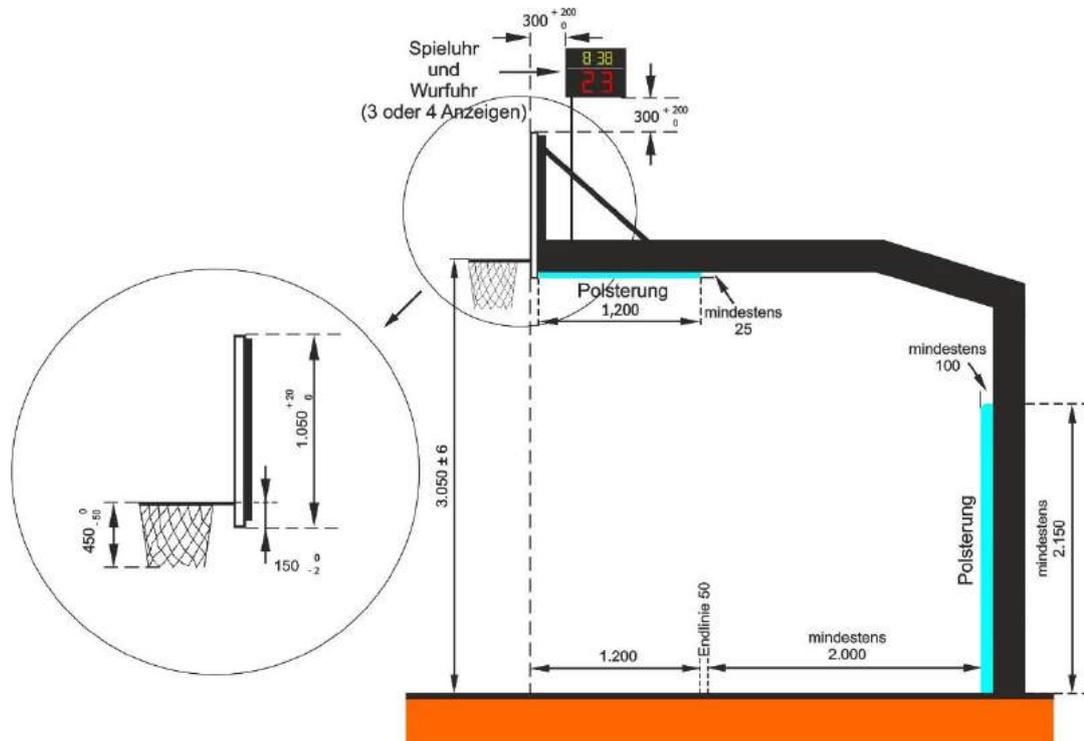
Bild 1 Korbanlage Stufe 1 (Wurfuhr Option 1)
